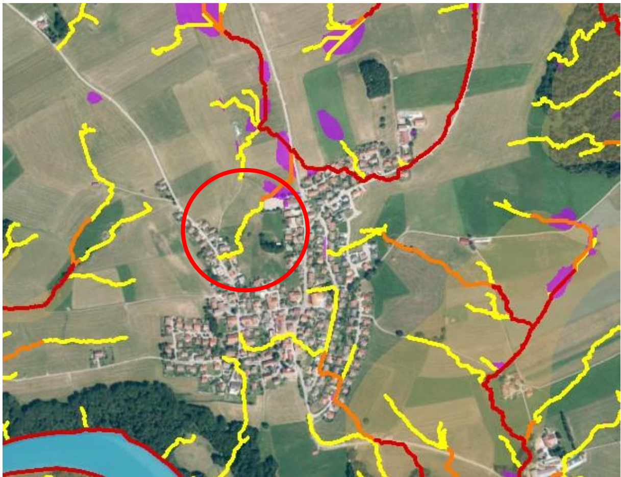
Abbildung 4: Potentielle Fließwege bei Starkregenereignissen (gelb: mäßiger Abfluss, orange: erhöhter Abfluss, violett: Aufstaubereich); Quelle: UmweltAtlas Bayern
